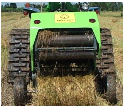
Bụng máy mở nhả cuộn rơm ra khi kết thúc គម្របបើកបញ្ចេញចំបើង MRB 0855T Rear cover opened after baling
