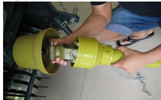
Lắp trục truyền động PTO ភ្ជាប់អ័ក្ស PTO Installation of PTO shaft
