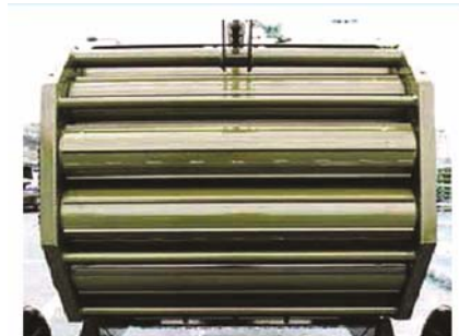
2- Ru lô trục cuốn nén rơm រូឡូម្លូរ និងសង្កត់ចំបើង Straw rolling and pressing rollers
