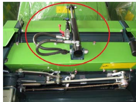
4- Cánh tay thủy lực mở cửa ប្រព័ន្ធអ៊ីដ្រូលិកបើកបញ្ចេញ រមូរចំបើង Hydraulic cylinder to open and release the rolled bale
