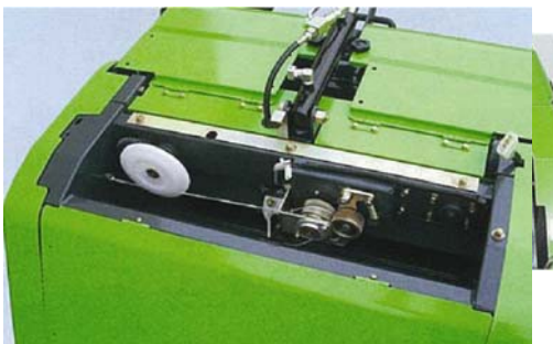
3 - Bộ phận buộc dây tự động khi kết thúc cuộn rơm. ប្រព័ន្ធស្តុស្សយប្រវត្តិ Auto twine threading system
