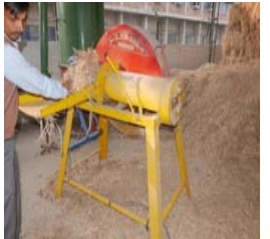
ម៉ាស៊ីនចំបើង ខ្នាតតូច មានកាំបិតវិល Farm-scale chopper: rotary knives
